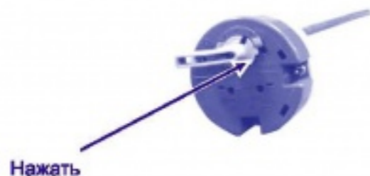
Рис.4. Расположение штока на термовыключателе термостата
