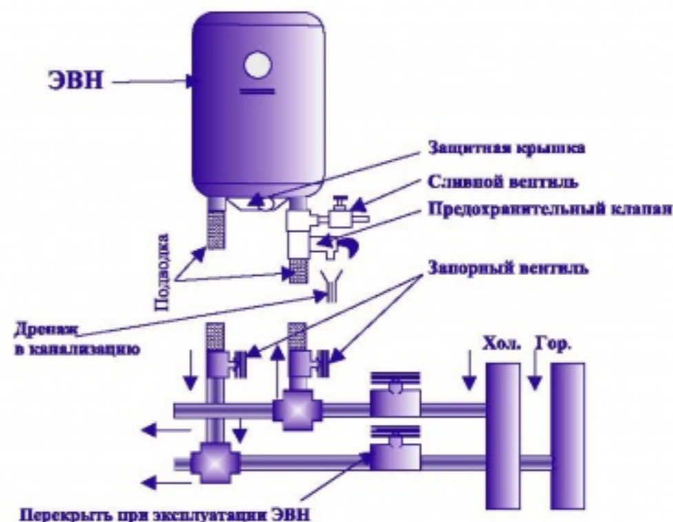
Рис. 1. Схема подключения ЭВН к водопроводу
